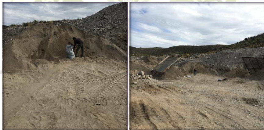
Figura N° 6.199: Extracción de la muestra de agregados de canteras de Mollebaya y Pampa Usuña Fuente: Elaboración propia
