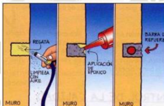
Figura N° 9.06: Reforzamiento del muro Fuente: AIS, 2002
