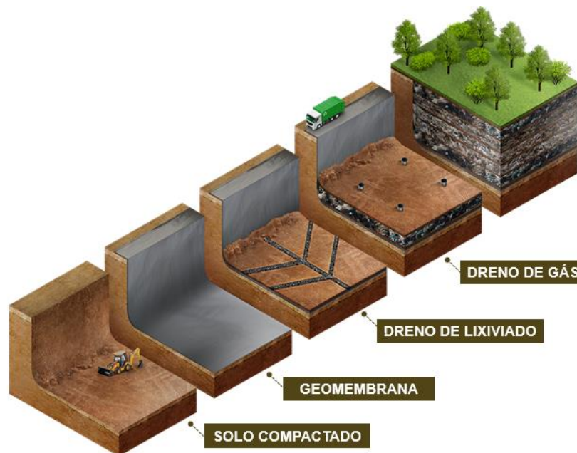
Figura 3.1 – Ilustração dos componentes de um aterro sanitário. Fonte: Adaptado de Grupo Seleta. Disponível em < http://www.gruposeleta.com.br/servicos/disposicao-final-tratamento-de-residuos/aterro-classe-ii-a >.
