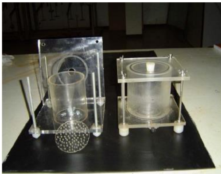
Figura 3.11 – Células de acrílico para ensaio de difusão, desmontada e montada. Fonte: Gurjão, 2005.
