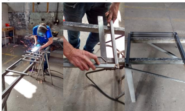
Figura 155 - Processo de montagem da estrutura inferior
