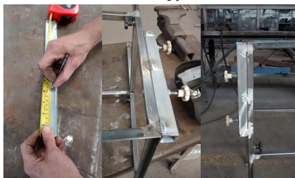
Figura 164 - Procedimentos de concepção da base da barra de apoio
