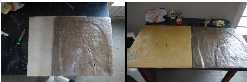
Figura 169 - Peça customizada do assento e manta de borracha esponjosa
