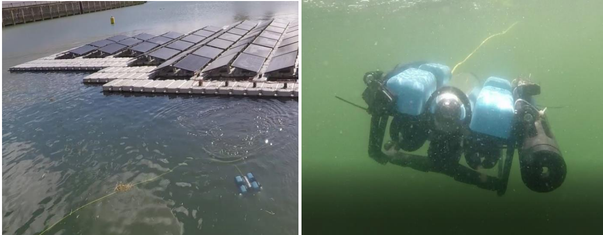
Afbeelding 5. Links: meetlocatie in Rotterdam met onderwaterdrone (rechts onder op foto), Locatie https://www.climatescan.nl/projects/4360/detail rechts: onderwaterdrone of aquatische remote operated vehicle (ROV) in actie
