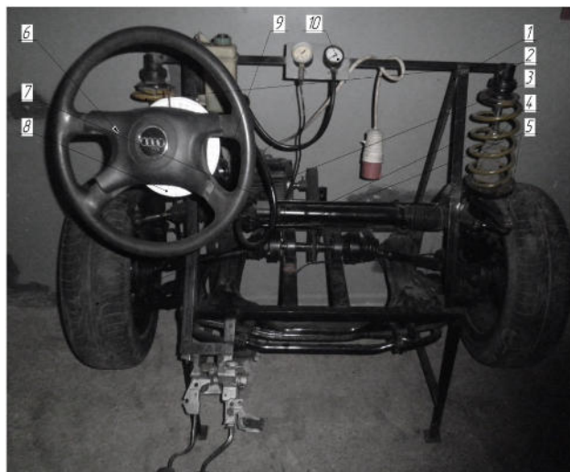
Рис. 1 - Стенд для дослідження параметрів гальмівних властивостей автомобіля
