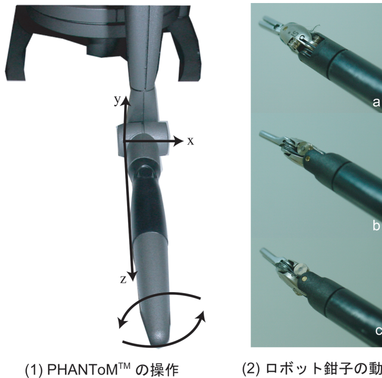
図 3-9 ロボット鉗子のリンク F_2 におけるキャリブレーションによる回転角度の同定
