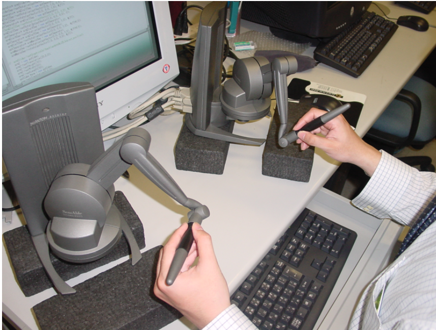
図 3-4 ロボット手術シミュレーションに使用する力覚フィードバックデバイス PHANTOM™の外観と設置状況
