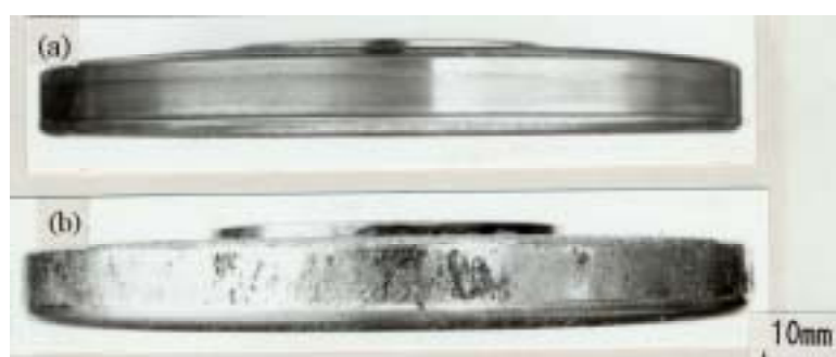
写真 6-3 転動疲労試験後の外観
