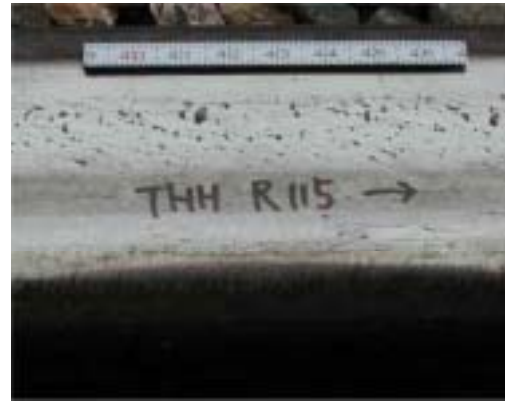
写真 6-1 高強度ベイナイト鋼と熱処理型パーライト鋼の敷設試験状況 (左：高強度ベイナイト鋼、 右：熱処理型パーライト鋼)
