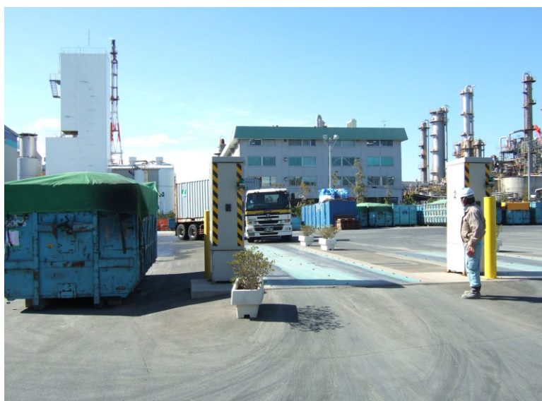
図5.5 排出事業者におけるトラックスケール
