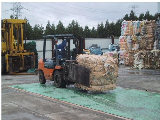
図6.4 圧縮済廃プラスチックと積み込みの様子
