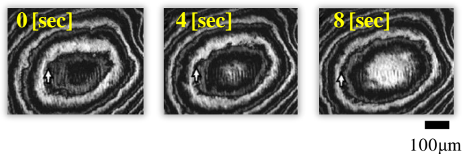
図 2.4 反射型偏光顕微鏡で観察されるキラル液晶膜の歳差運動
