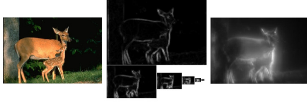
図 3.3.3.1.2.1 Multi-scale Contrast の出力結果[22]
