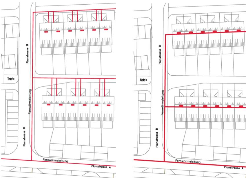
**Abb. 4-30** Vergleich der Fernwärmeanbindung über klassische Stichleitungen (links) versus Verlegung durch die Häuser (rechts)
