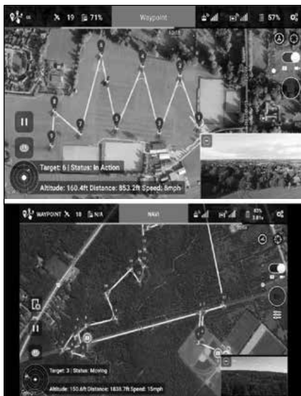
Slika 10. Izrada plana letenja pomoću putnih točaka (točaka interesa) u aplikaciji LITCHI for DJI
