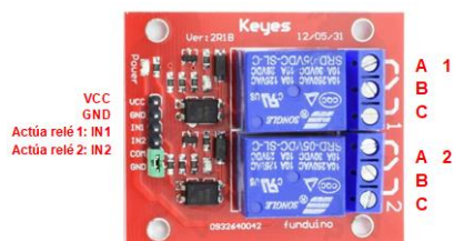
Fig. 6. Módulo relé 2 canales SRD-05VDC-SL-C
