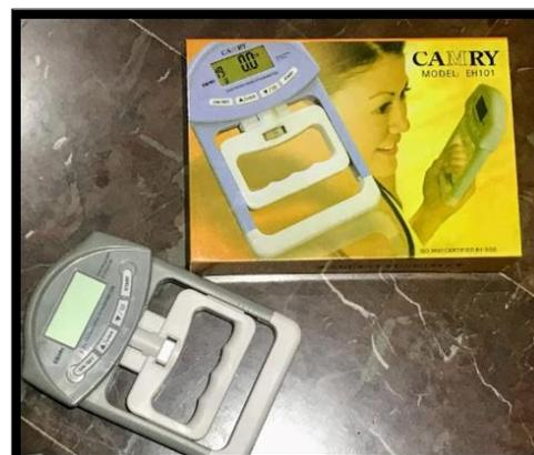
**Figura 16.** Dinamómetro manual “CAMRY EH101” Fuente propia.
