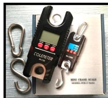
**Figura 17.** Dinamómetro “Colemeter WH-C300”. Fuente propia.
