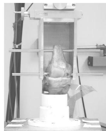
Figura 27. Metodología del estudio para medir diferentes niveles de presión en rodillas cadavéricas (Lee et al., 2006).
