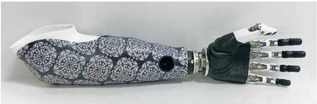
KUVA 4. Esimerkki myoelektrisestä proteesista. (Kuva: Tiina Rossi/Respecta Oy).
