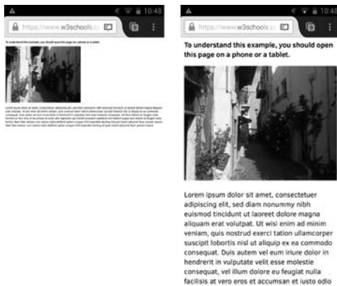
Figura 5. A l'esquerra, pàgina web sense la finestra gràfica adaptada a la mida del dispositiu —en aquest cas, un mòbil. A la dreta, la mateixa pàgina amb la finestra gràfica configurada per adaptar-se a la mida de la pantalla. 36
