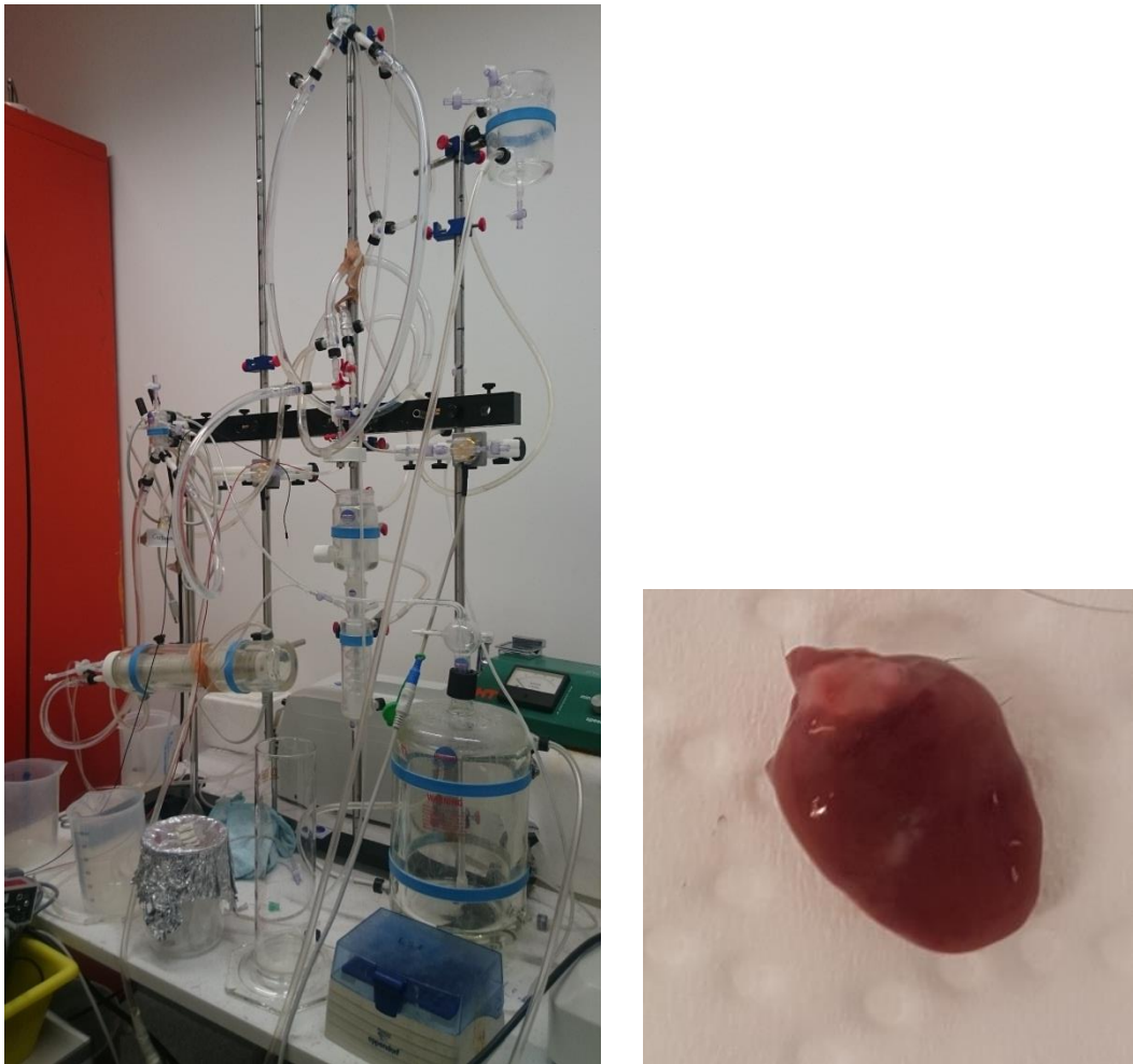
Abbildung 7: Aufbau des Langendorff-Apparates und ein präpariertes Pg-KO-Herz
