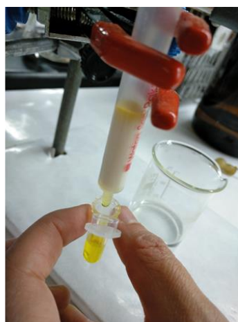
7. Elución de carotenos con éter de petróleo/acetona (95:5, v/v)
