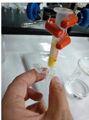
7. Elución de carotenos con éter de petróleo/acetona (95:5, v/v)
