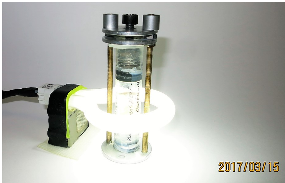
Abbildung 33: Injektionspritze bei der Lichtpolymerisation mit Probe und Technovit® 7200 in der Spannvorrichtung
