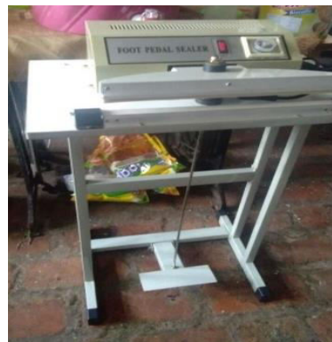
Gambar 3 Pedal sealer dan spesifikasinya
