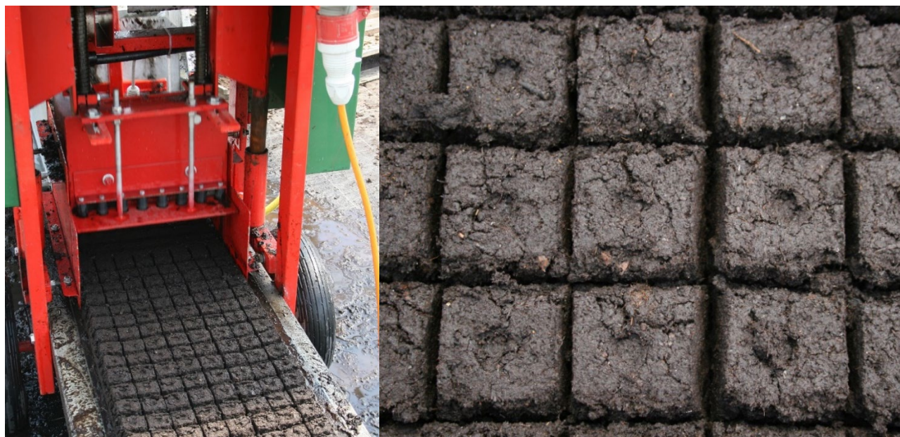
Abb. 1: Probepressungen mit der mobilen Erdpresstopfmaschine (linkes Bild) und erzeugte Erdpresstöpfe in guter Qualität (rechtes Bild). Foto: Guido Kunz
