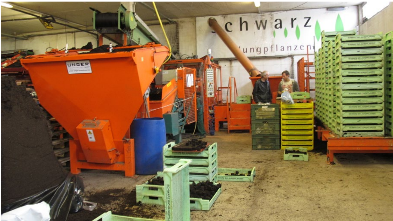
Abb. 4: Maschinelle Produktion von Erdpresstöpfen. Die Töpfe werden automatisch in Kisten gefüllt und mit der angeschlossenen Sählinie mit Saatgut von Kopfsalat und Fenchel belegt
