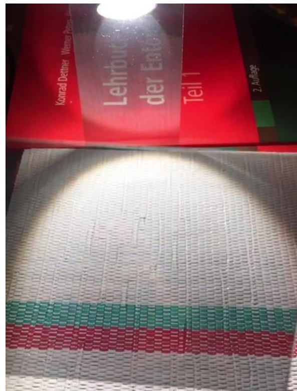
Abbildung 32: Dieselbe Reflexion auf «Lumilys weiss» durch einen horizontal ausgerichteten Polarisationsfilter (s-polarisierend): es ist kaum eine blendende Reflexion zu sehen
