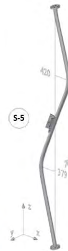
b) Deformaciones plásticas en pierna a 18 m. de altura
