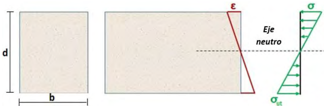
Figura 2-10 Diagrama de estados de esfuerzo y deformación para vigas a flexión.
