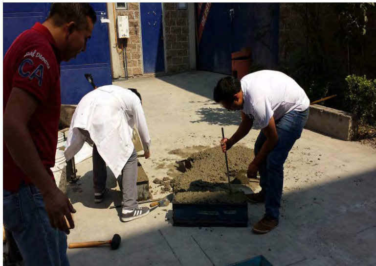
Figura 4-9. Varillado y enrasado.
