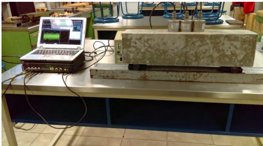
Figura 4-14. Medición con acelerómetros.
