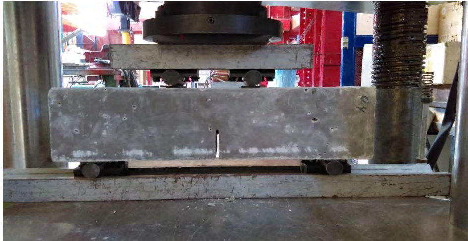
Figura 4-16. Prueba a flexión con carga en los tercios del claro.
