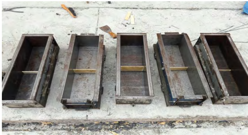
Figura 4-6. Moldes para vigas de acero inoxidable.
