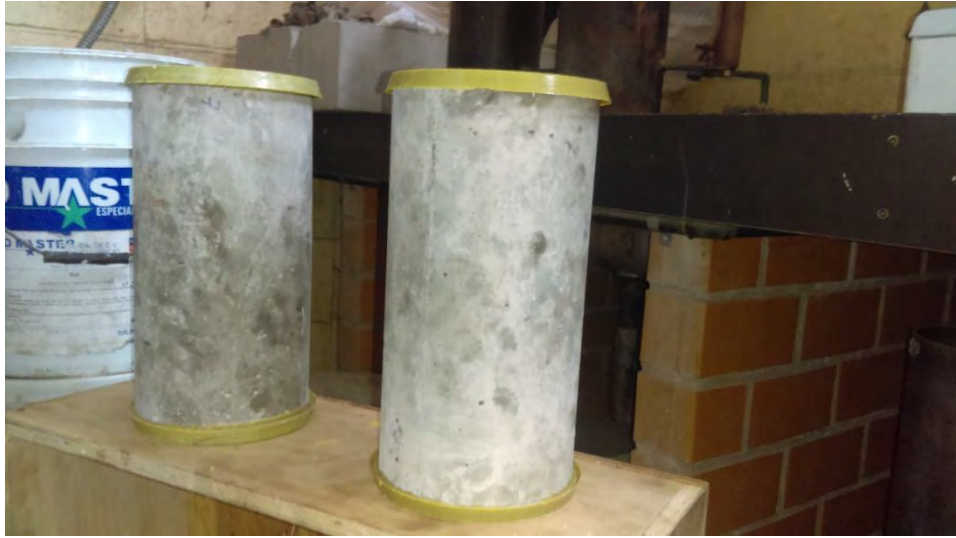
Figura 4-10. Cilindros para verificar la resistencia a compresión.
