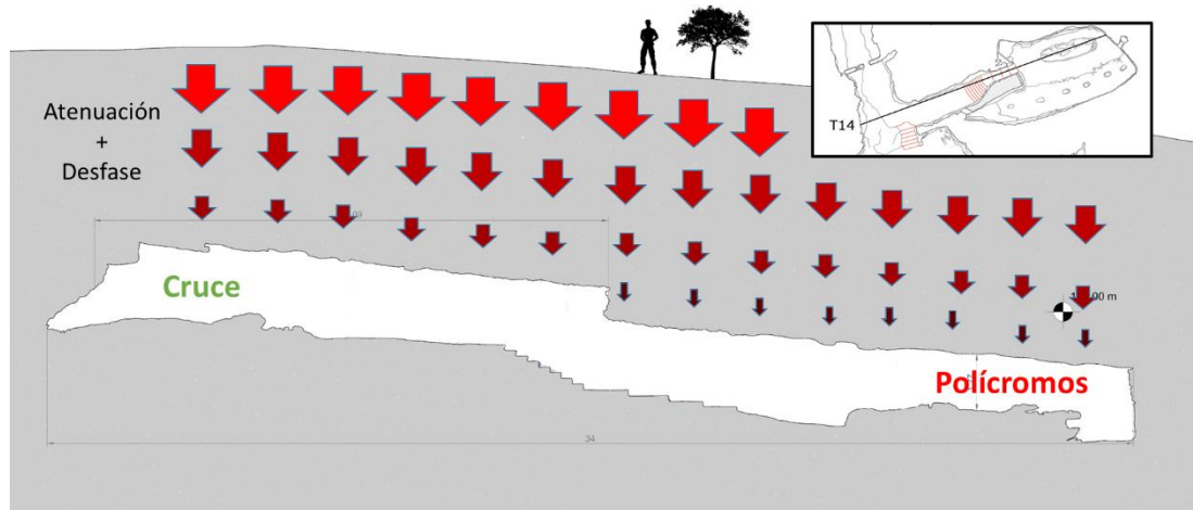
Figura 15. Esquema de la propagación de la onda térmica en la cobertera situada por encima del Cruce y de la sala de Polícromos.
