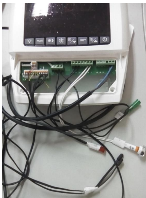
Figura 7: Dixell XLR170 com as ligações dos leds e das sondas
