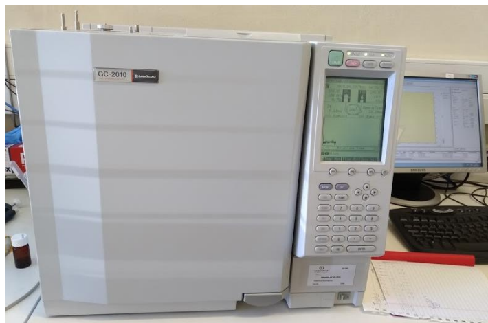
Figura 20 - Cromatógrafo gasoso com detetor de ionização de chama (GC-FID).
