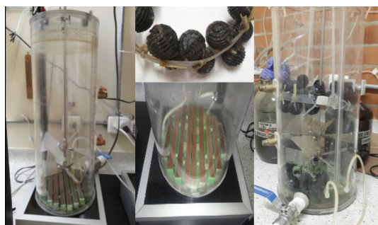
Figura 1. Detalles constructivos del SBR a escala laboratorio.
