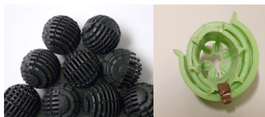
Figura 2. Medios de contacto empleados en el reactor SAG-SBR, biobolas y cilindros.
