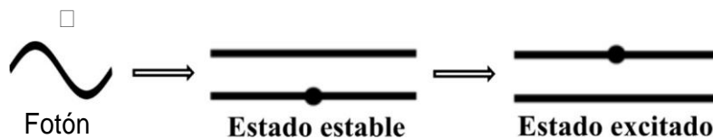
Figura 2.3. Proceso de absorción atómica.
