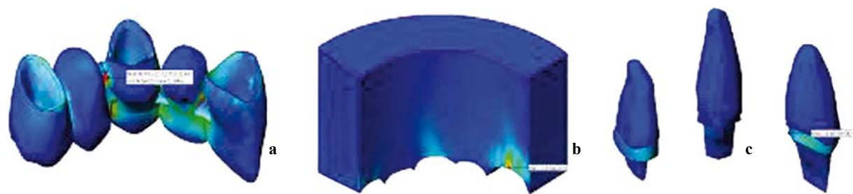
Figura 8. Esfuerzos von Mises en modelo no rígido con situación de carga 4 (sobre pilares y pónicos). Restauración (a), hueso (b) y raíz con ligamento periodontal (c)
