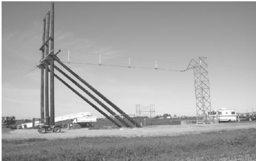
Figura 10: Modelo de torre ensayada y ensayo a escala real (Lee & McClure, 2007).
