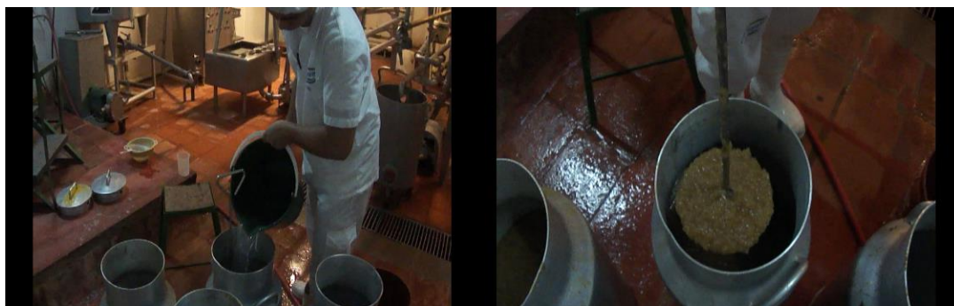
Figura A5.10 Proceso de precipitación (adición de alcohol y agitación manual)
