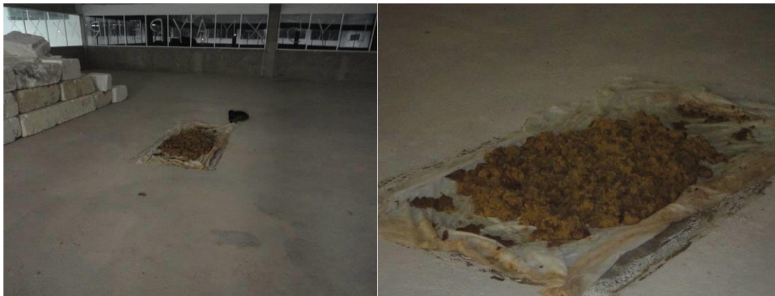
Figura A5.12 Secado de pectina al aire
