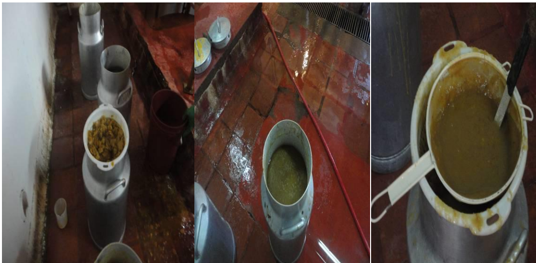
Figura A5.9 Proceso de filtración del extracto de pectina de naranja
