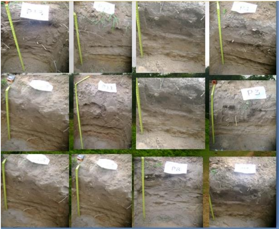
Figura 0.8 Calicatas con los perfiles del suelo y ubicación de los puntos de muestreo.
