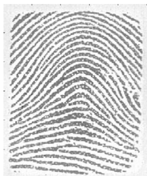
Figura 5 Imagen de una huella dactilar adquirida con el sensor capacitivo
