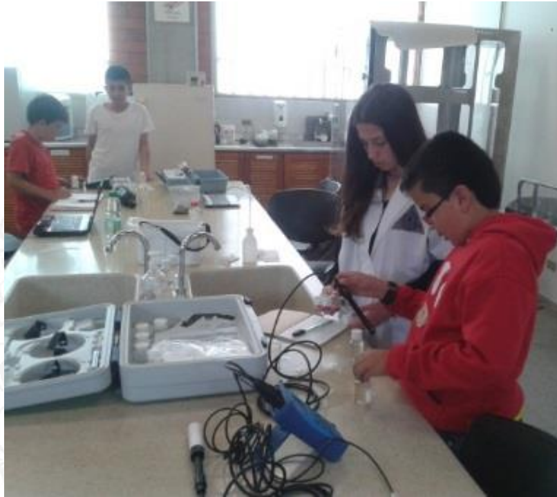
Imagen N° 13: Análisis de muestras de agua –PH, Conductividad eléctrica y turbidez–.
