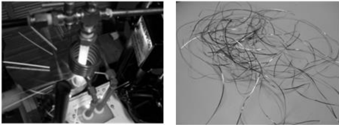
Figura 1. Obtención de cintas metálicas por la técnica Melt Spinning. Se aprecia en primer plano la bobina y las cintas obtenidas.
