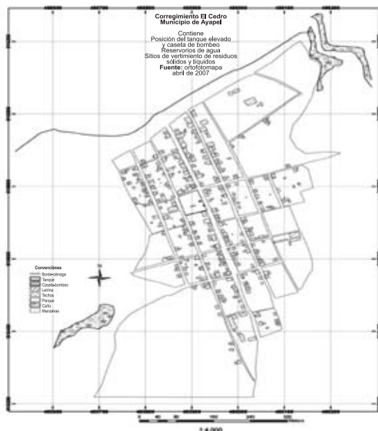
Figura 4. Posición relativa del tanque de agua, estación de bombeo, reservorios de agua aledaños y descargas puntuales de ARD. La escorrentía de aguas residuales domésticas y vertimiento de residuos sólidos se efectúa en todo el casco urbano.
