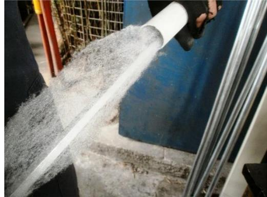
**Figura 63. Relleno del tubo PVC con material absorbente acústico**
