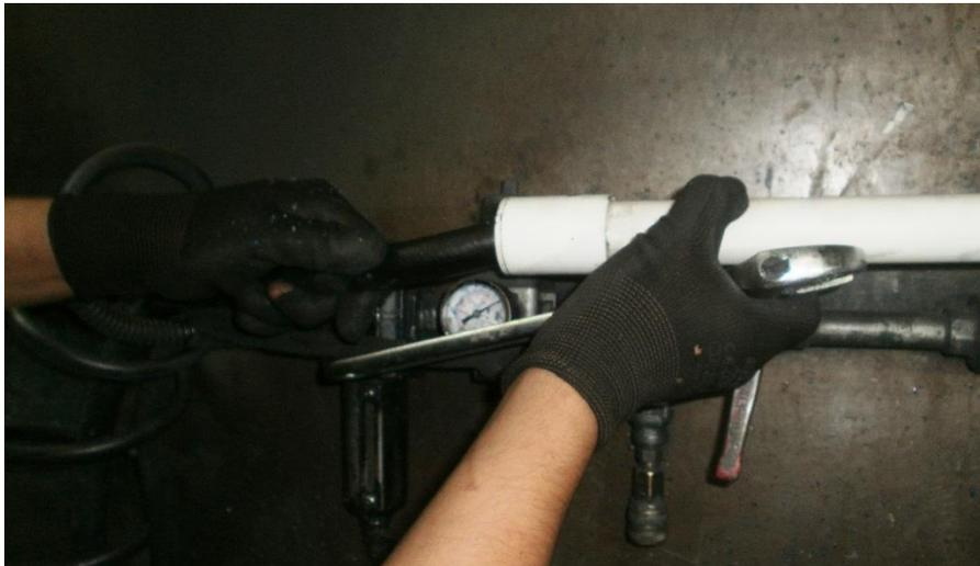
**Figura 64. Proceso de ensamble del tubo PVC con la manguera del silenciador instalado.**
