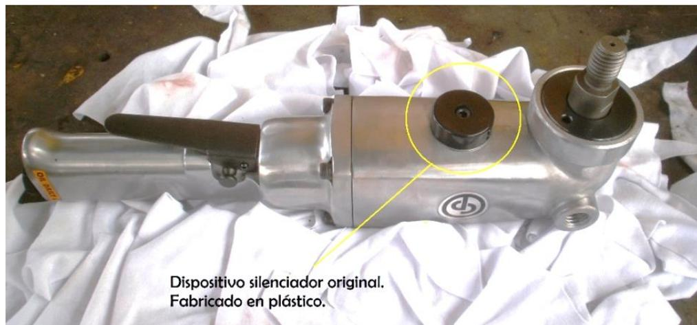
**Figura 55. Herramienta con dispositivo silenciador, original**
