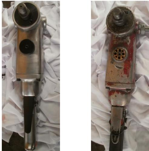
**Figura 13. Pulidora Neumática, nueva (izquierda) y Pulidora Neumática usada sin silenciador (derecha)**
