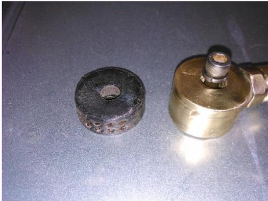
**Figura 61. Dispositivo silenciador original (plástico) y dispositivo silenciador instalado (cobre).**
