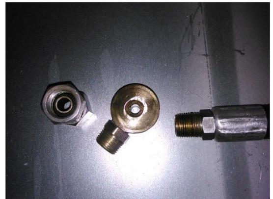
**Figura 57. Partes del silenciador instalado, antes del ensamble**
