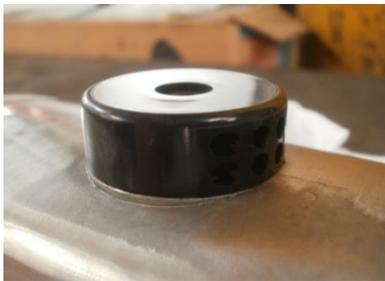
**Figura 14. Dispositivo original de reducción de ruido**
