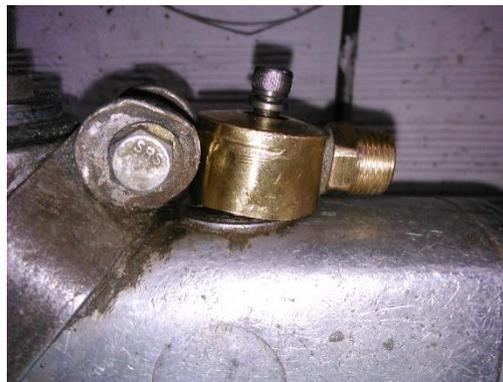
**Figura 60. Acople instalado a la herramienta**
