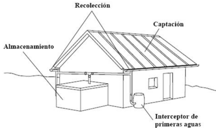
Figura 5. Sistema típico de captación de agua lluvia en techos.
