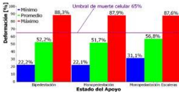
Figura 8. Deformaciones máximas, mínimas y promedio debido a las condiciones de carga. Fuente. Elaboración propia.
