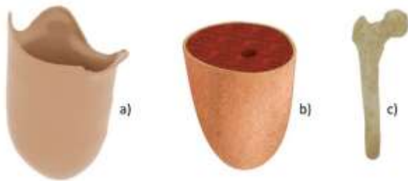
Figura 2. Modelos CAD (a) Socket, (b) Muñón multicapa y (c) Hueso. Fuente. Elaboración propia.
