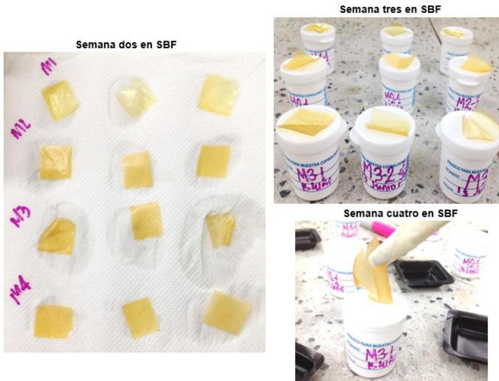
**Figura 26.** Degradación en el contorno de las películas en los días 7, 14 y 21.
