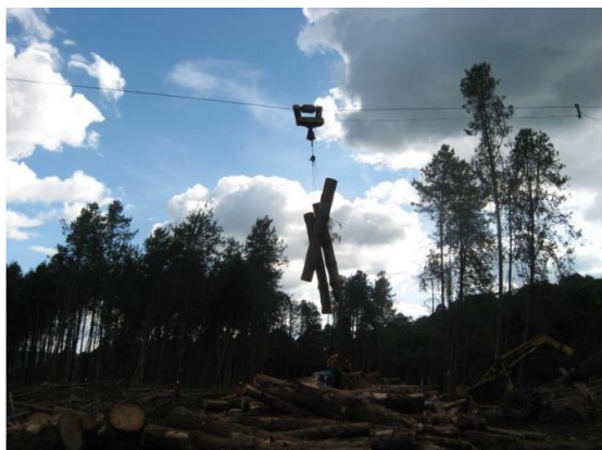
Foto 13. Cosecha con cables aéreos. Fuente: Resumen Público Plan de Manejo Forestal. Septiembre de 2013.
