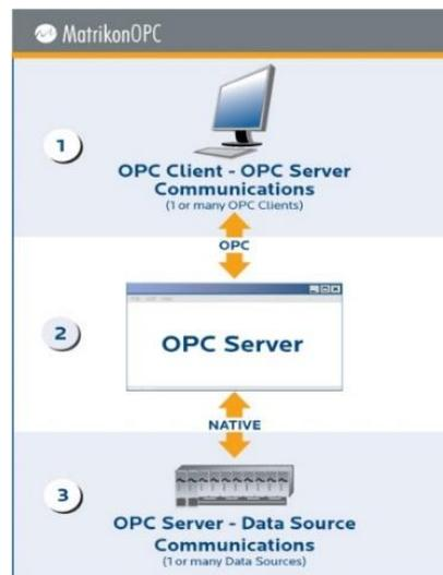
Figura 6. SCADA básico basado en OPC
