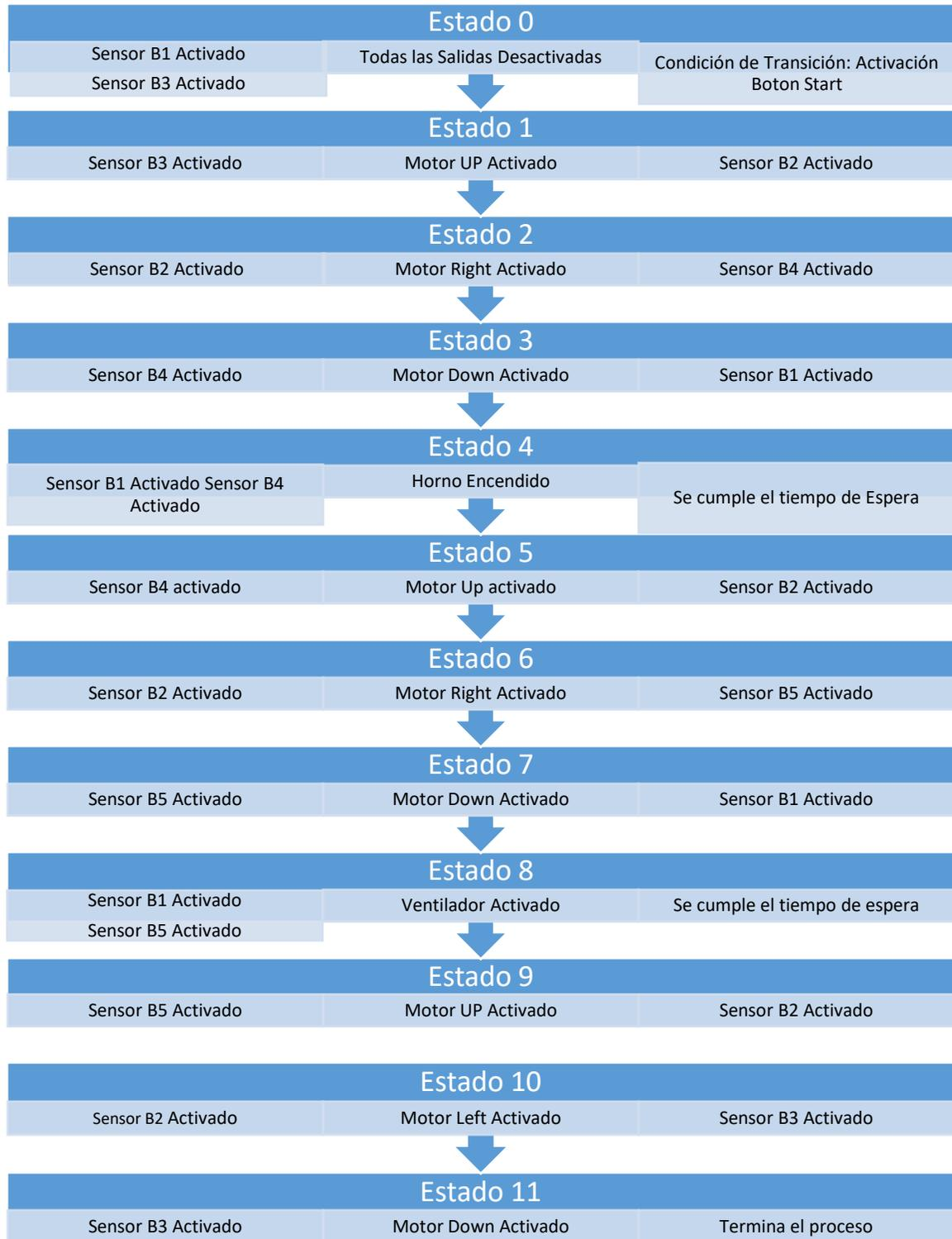
Figura 21. Diagrama de estados del Proceso
