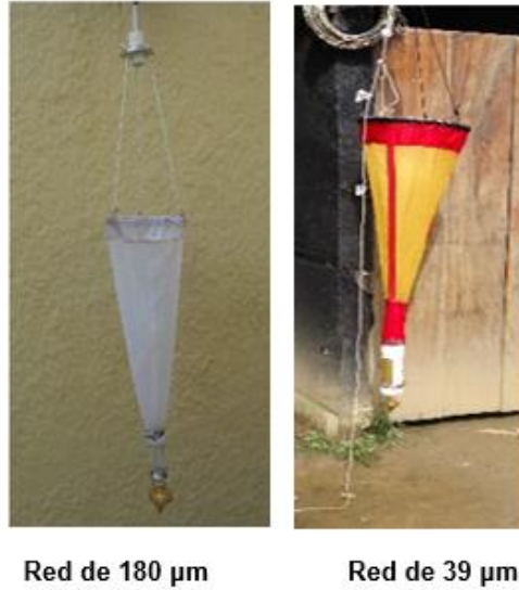
Figura 4.3. Redes zooplancton modificadas de 180 y 39 \mu\text{m}
