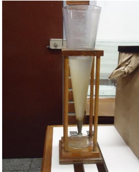
Figura 3.8. Montaje de sedimentación usando el cono Imhoff
