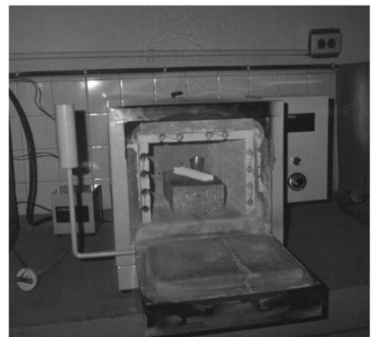
Figura 3 Bloque M3 en el horno. Dimensiones después de tratamiento térmico; largo: 9,1 cm, ancho: 1,7 y espesor: 0,7
