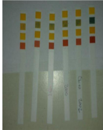
\*Varillas medidoras de PH utilizadas en cajas y periódicos
