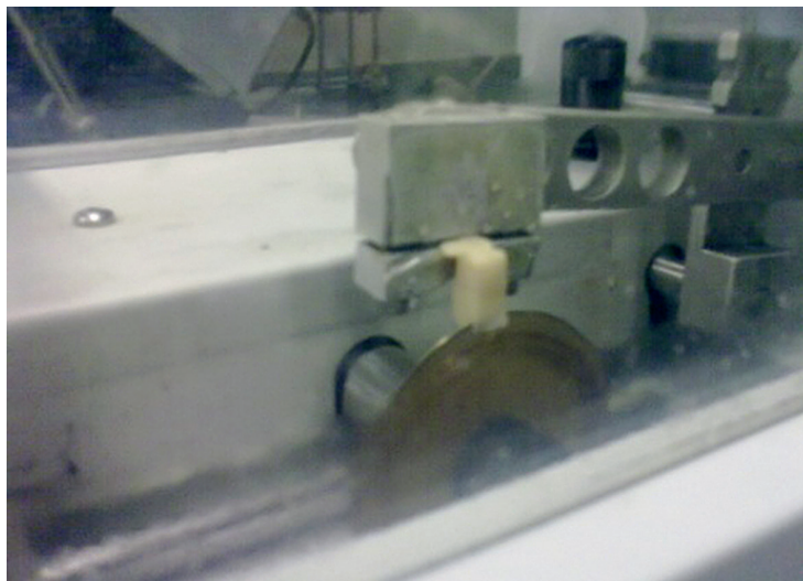
Figura 2. Seccionado de una de las muestras en la cortadora Buehler Isomet 1000 Precision, posterior a su proceso de cementación
