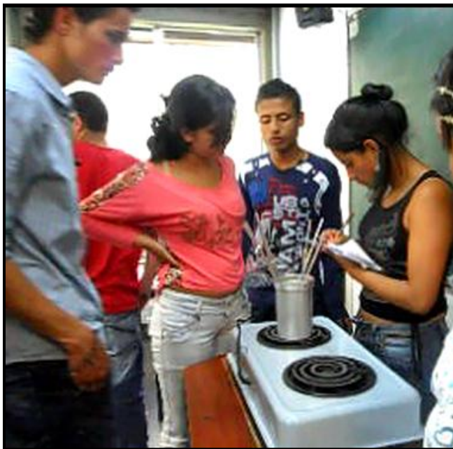
Foto 13. Calibración de los termómetros. Instalaciones de la U de A
