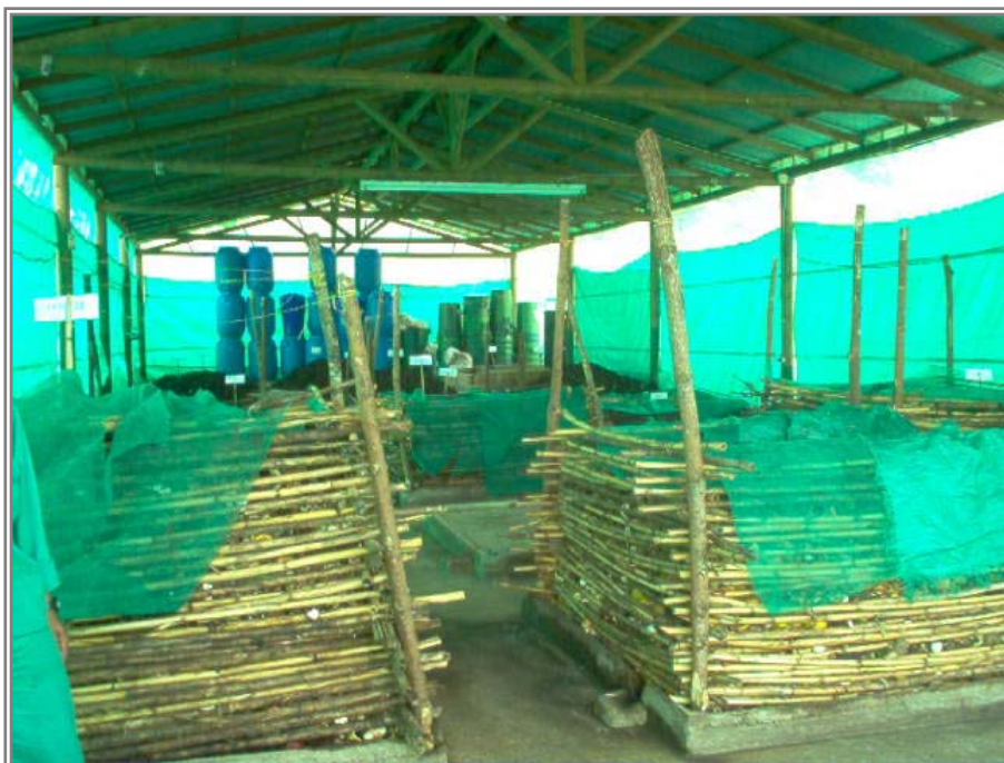
Foto 9. Formación de pilas para el aprovechamiento de los residuos orgánicos, corregimiento de Altavista.
