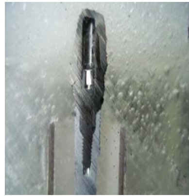
Figura 4. Corte transversal para posterior medición del ajuste interno. Grupo aleación metálica, muestra 1
