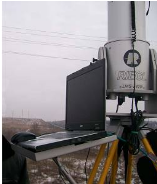
Рис. 8.2. Наземна лазерна сканувальна система Riegl LMS-Z420i
