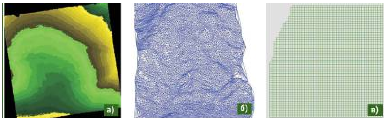
Рис. 8.5. Цифрова модель рельєфу: а) растрова; б) TIN; в) GRID
