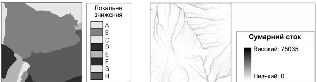
Рис. 10.34. Приклад поверхні басейнів стоку і поверхні сумарного стоку, отриманої за допомогою поверхні напрямку стоку
